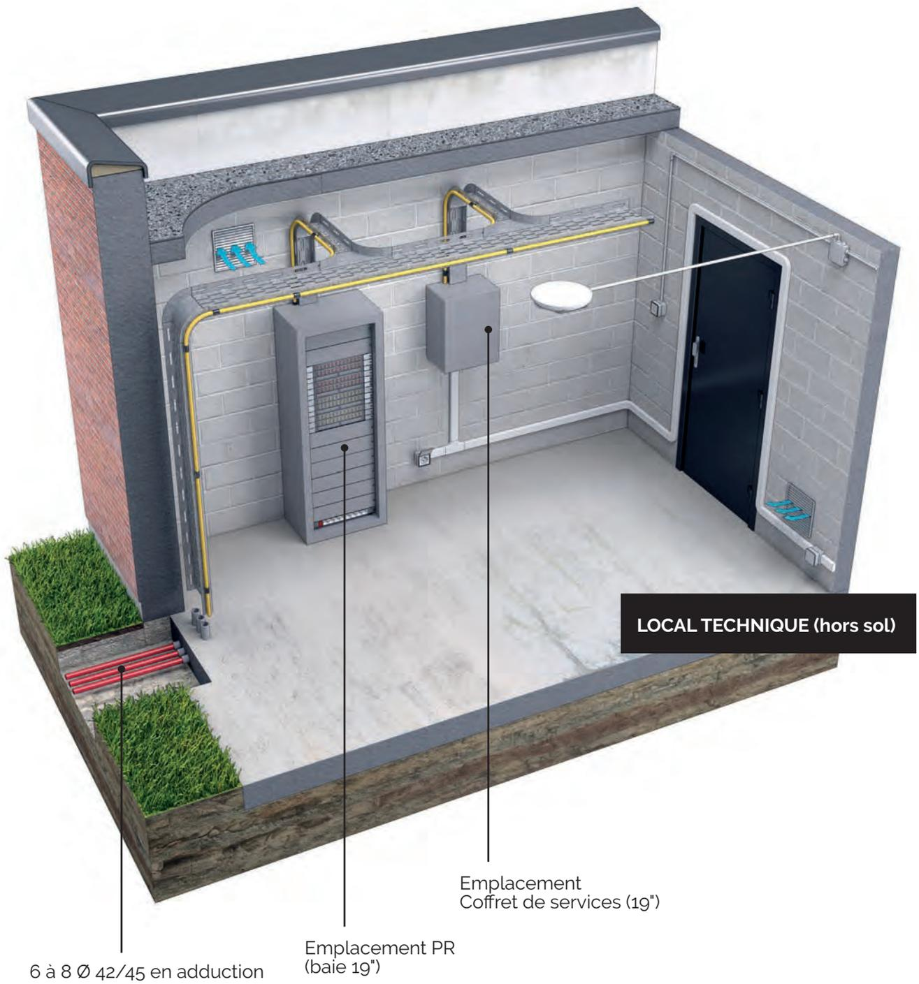
Fig. 87 | Exemple d'un PR à partir d'un répartiteur optique au standard 19".
