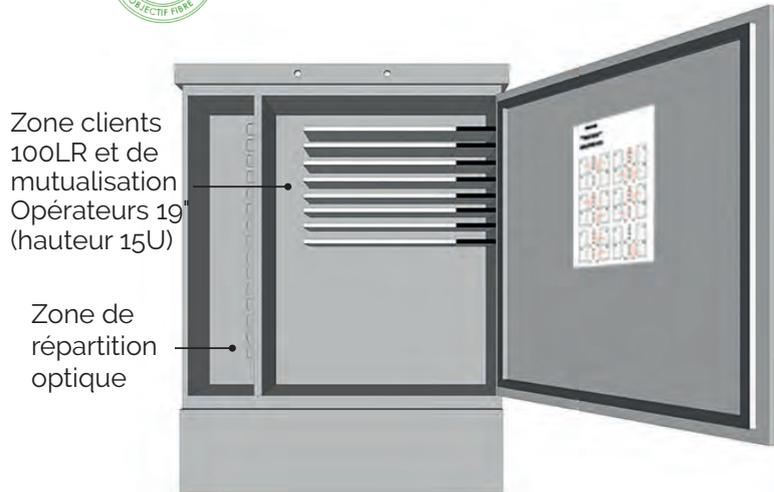
Fig. 89 | Exemple d'une jonction Point d'entrée/PR (armoire de rue)
