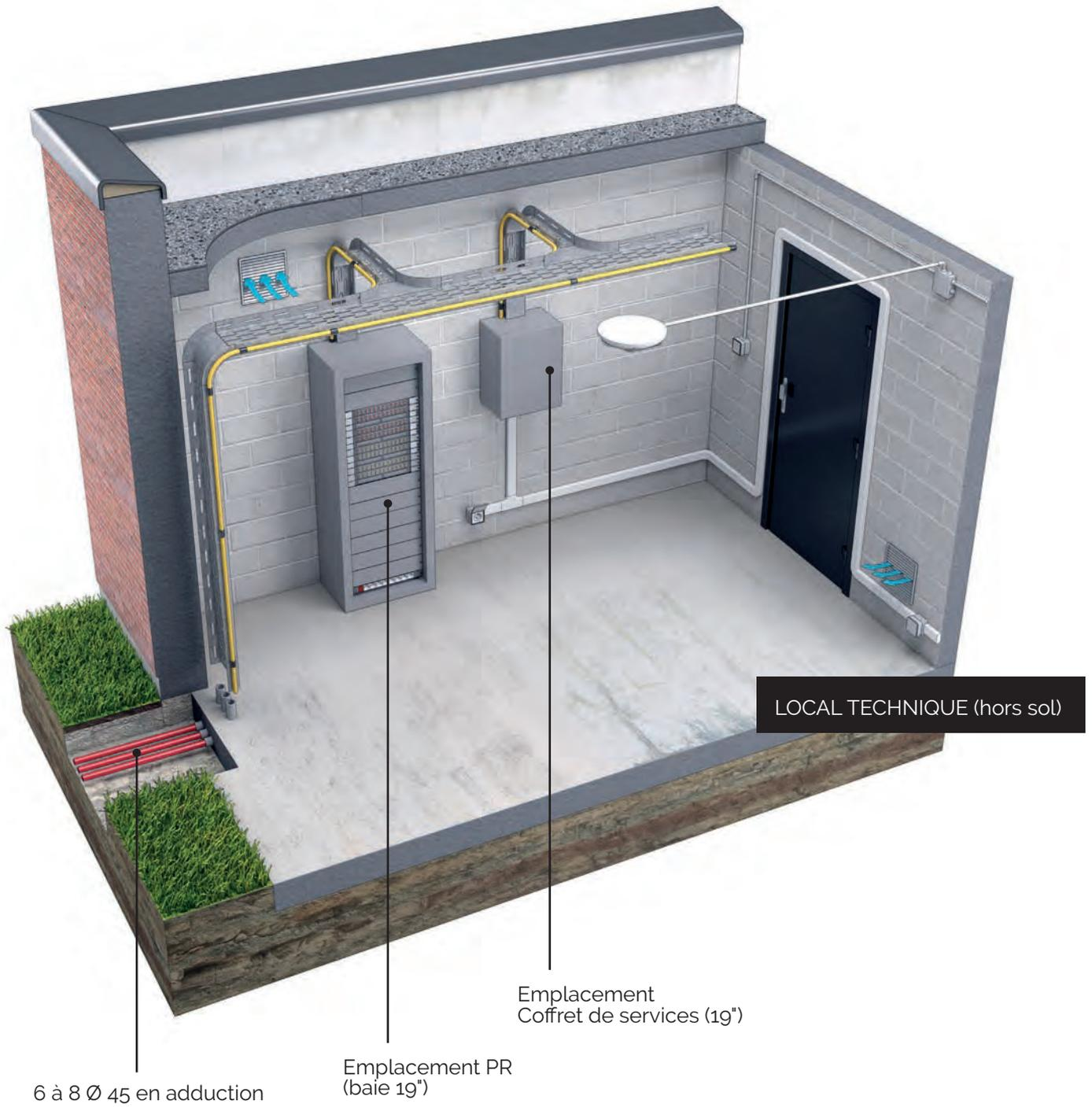
Fig. 87 | Exemple d'un PR à partir d'un répartiteur optique au standard 19".
