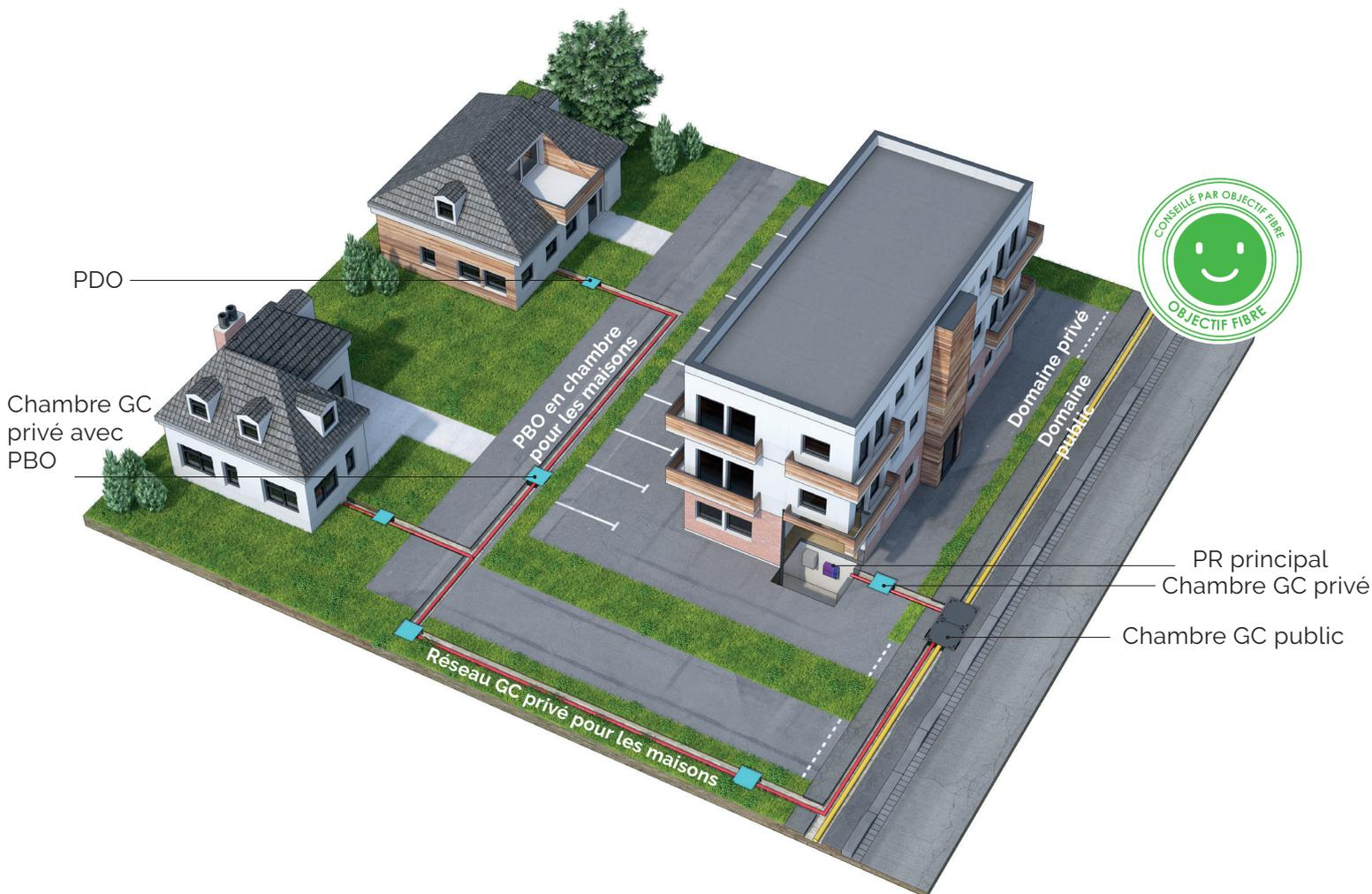
**Fig. 52 | Synoptique d'un câblage type pour un campus privé composé d'immeubles et de locaux individuels sans PR commun**
