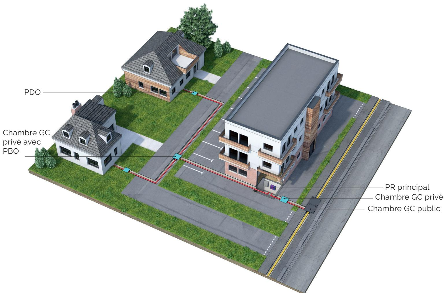
**Fig. 50 | Synoptique d'un câblage type pour un campus privé composé d'immeubles et de locaux individuels avec PR commun en immeuble**
