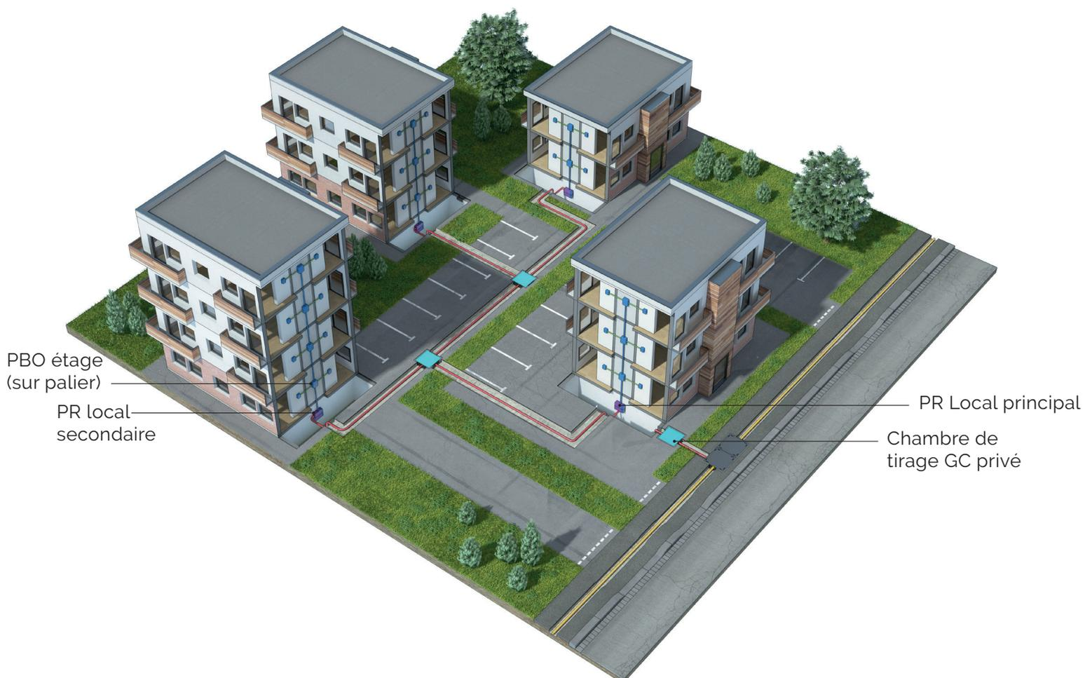
La pose de la fibre optique entre le point de raccordement (PR) et le domaine public est de la responsabilité de l'opérateur. La pose du PR et les infrastructures de cheminement jusqu'au domaine public au droit du terrain sont à la charge du maître d'ouvrage, y/c l'aménagement du domaine privé.
