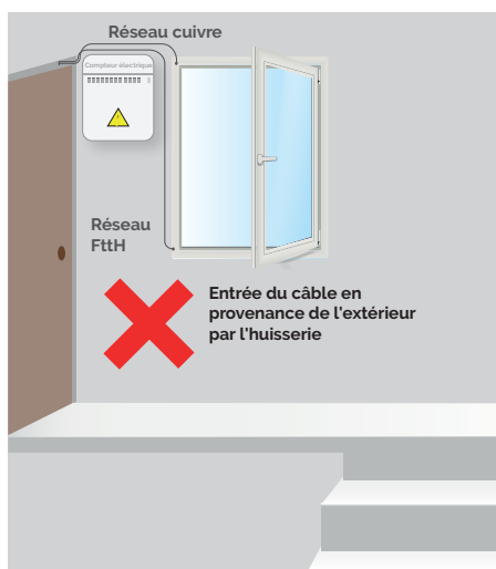
Fig. 40 | Cas d'une intervention chez le client avec parcours et percements ayant porté atteinte à l'esthétique du logement
