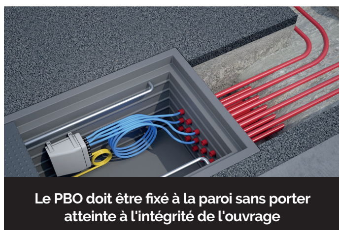
Fig. 59 | Sortie de câble au niveau du PBO en chambre souterraine
