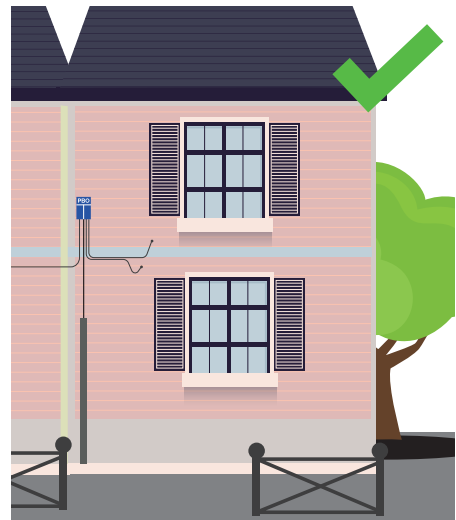
Fig. 35 | Cas de branchements en façade respectant les règles de l'art
