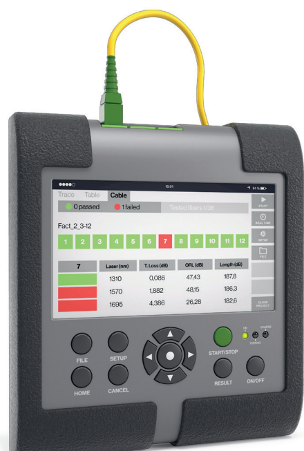
Fig. 116 | Multimètre fibre optique
