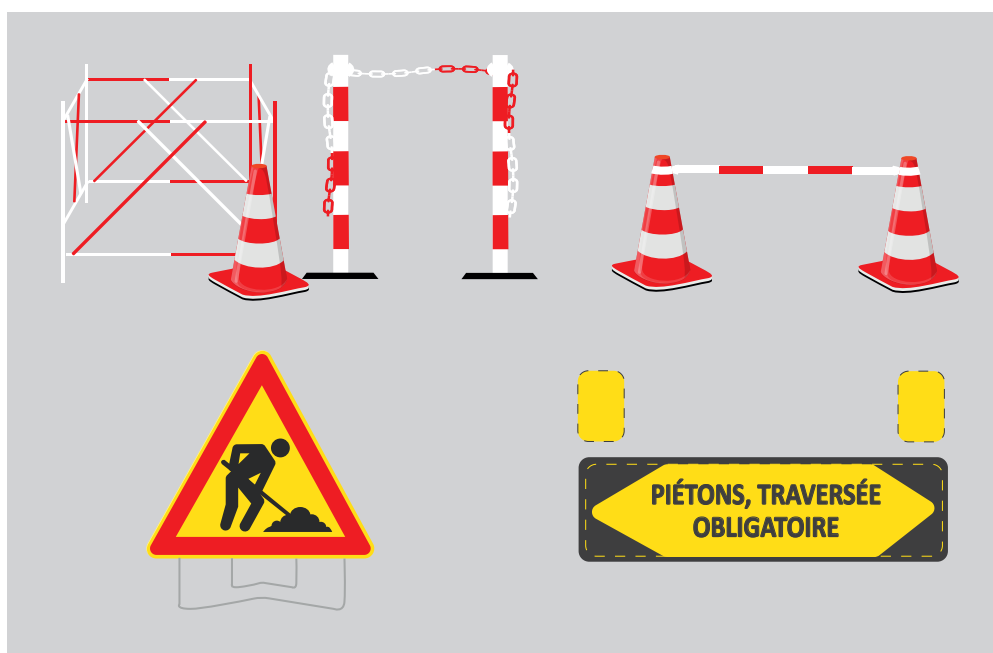
Fig. 43 | Protéger son chantier et le signaler
