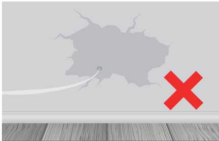
Fig. 36 | Cas d'un PBO et un parcours du câble en partie commune non conforme à l'étude initiale, avec percements non rebouchés
